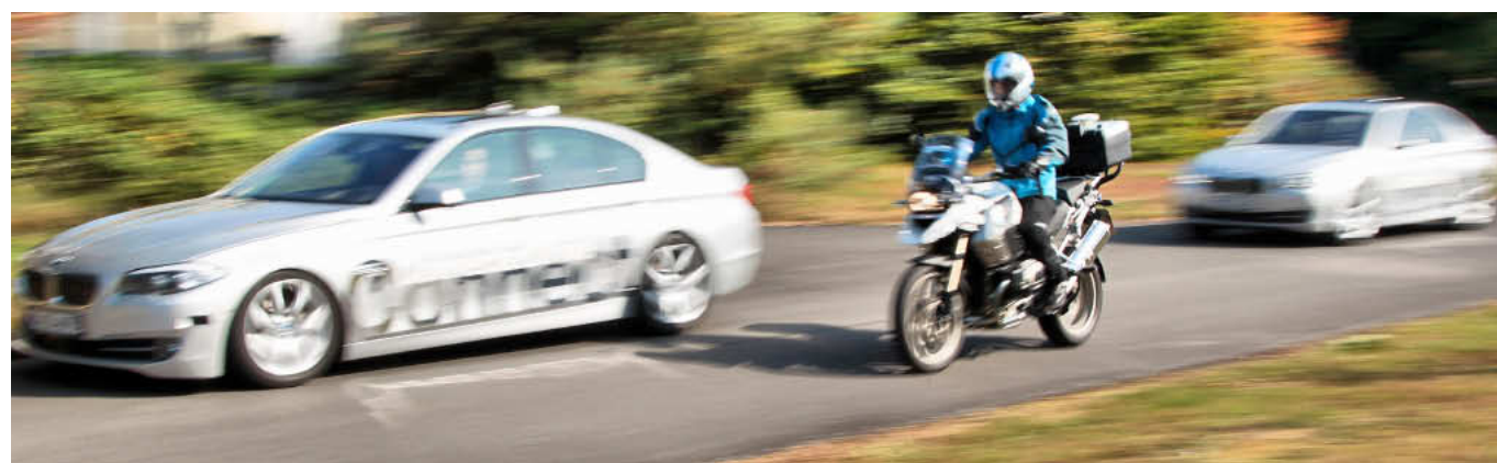
Ein Motorradfahrer überholt eine Autokolonne. Der Autofahrer im vorderen Wagen erhält vom hinteren Fahrzeug eine Warnung. Dessen Sensoren haben den Motorradfahrer erfasst und geben diese Information über W-Lan an alle Verkehrsteilnehmer in der Umgebung weiter.
