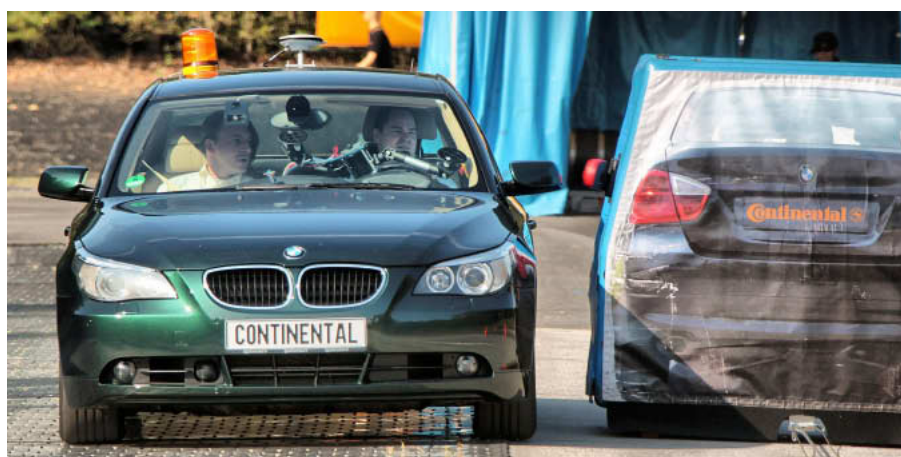
Selbstständig steuert dieser BMW durch einen kurvenreichen Parcours. So exakt, dass es jedes Mal dem entgegenkommenden Fahrzeug-Dummy (rechts) den Außenspiegel wegklappt.
