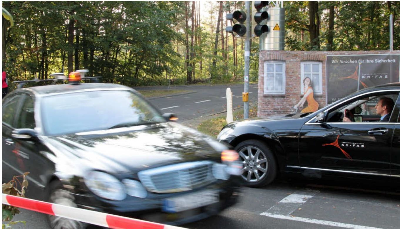
Versteckte Gefahren erkannt und gebannt. Dies zeigten zwei Demonstrationen auf dem Testgelände in Alzenau. Links stoppt ein Auto automatisch vor einem Fahrzeug, das ihm aus einer Seitenstraße heraus die Vorfahrt nimmt. Auf der ehemaligen Staatsstraße 2305 wird ein Fußgänger-Dummy überraschend vor ein fahrendes Auto gezogen, das sofort bremst. Sender in Auto und Kleidung warnen vor diesen Gefahren, noch bevor sie zu sehen sind. Fotos: Harald Schreiber
