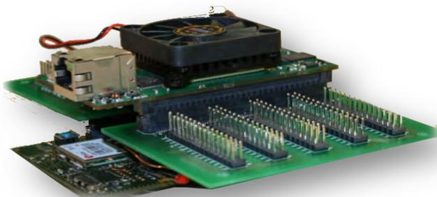
Abbildung 28: Finale Kommunikationsplattform (inkl. Debug-Header)
