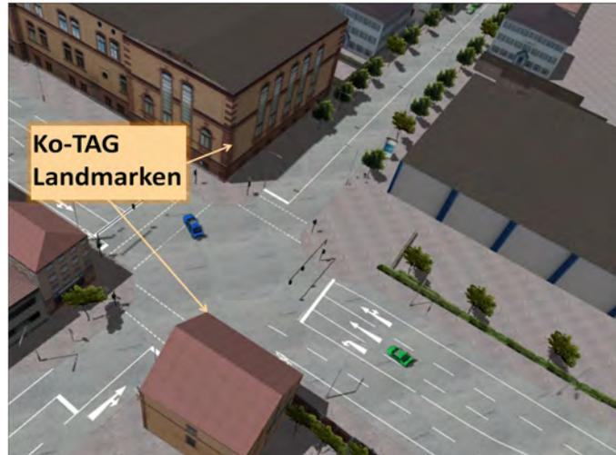
**Abbildung 130: Applikation der Ko-TAG Lokalisierung an der Ko-PER Versuchskreuzung mittels zweier, diagonal angeordneter kooperativer Landmarken in einer Höhe von ca. 4m und einem diagonalen Abstand von ca. 26,8m.**
