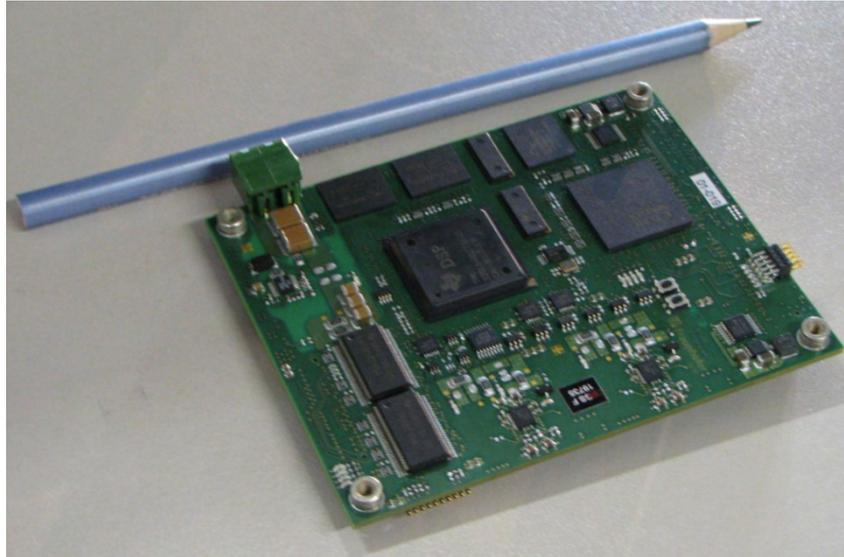
**Abbildung 52: Digitalboard basierend auf einem Spartan 3A-DSP und Ti64xx DSP**
