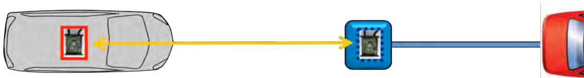
**Abbildung 141: Prinzip der eindimensionalen Objektreferenzierung für Notbremsassistenten**
