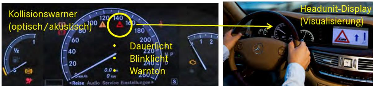
Abbildung 129: HMI HW-Schnittstellen im Versuchsträger
