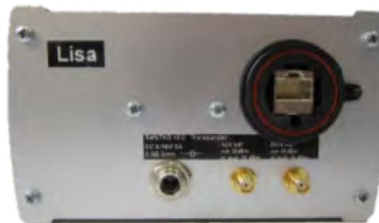
**Abbildung 2: Safetag v2.0 Frontblende mit den Anschlüssen Power (links), Antenne AUX (mitte) und Antenne MAIN (rechts), sowie Ethernet-Schnittstelle für Firmware-Update und Einstellungen**
