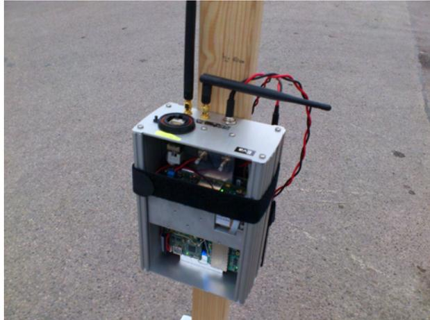
Abbildung 72: SafeTAG 2.0 Transponder mit 2 Antennen für Diversity-Betrieb
