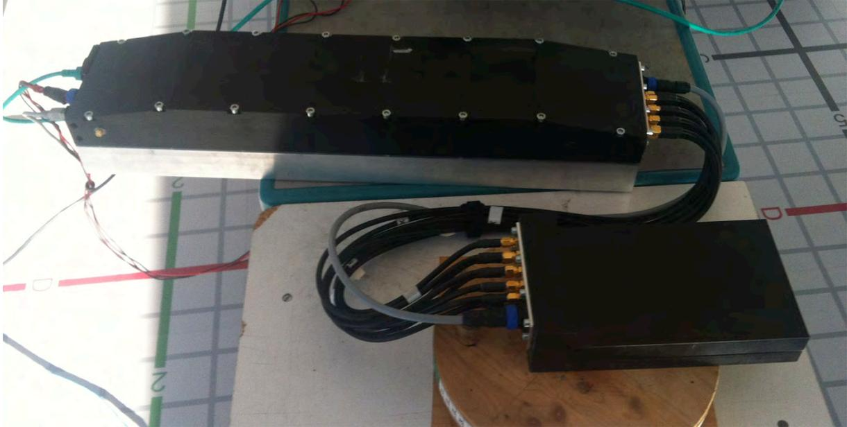
**Abbildung 44: Ortungseinheit mit abgesetzter Antenneneinheit**
