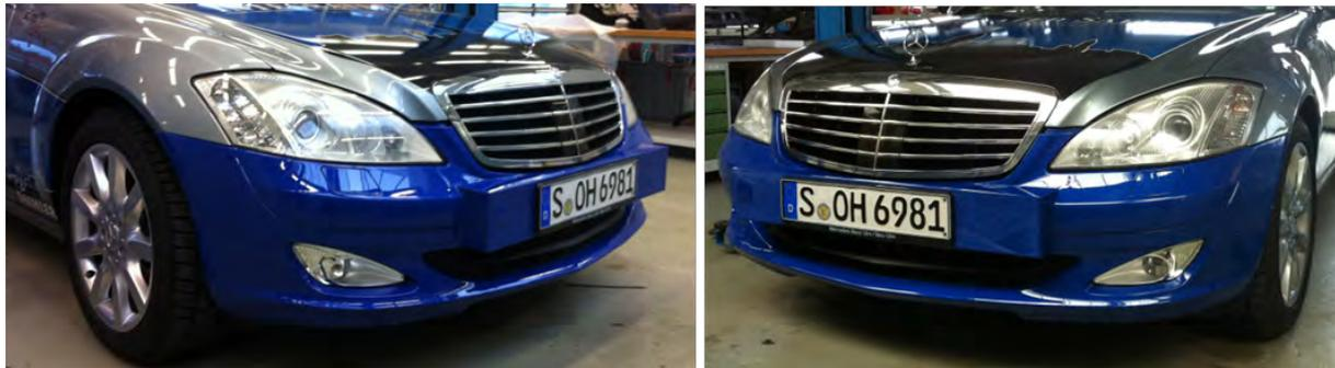
**Abbildung 127: Modifizierter Stoßfänger mit "Rapid Prototyping" OBU-Haube**
