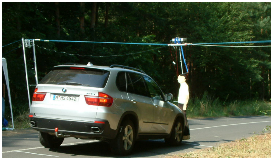
Bild 5: Schutzkonzept autonome Notbremse im Einsatz mit Fußgängerschutztestanlage
