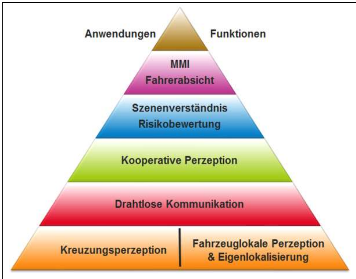
Abbildung 2: Schichtung der Ko-PER Informationsverarbeitungsmodulen; in der Nähe der Basis der gedachten Pyramide sind sensornähe, im Bereich der Spitze dagegen sensorferne Verarbeitungsschritte angesiedelt.
